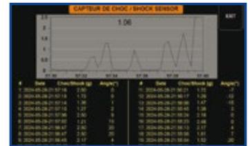
Capteur de chocs et des angles d'inclinaison de la souffeuse
